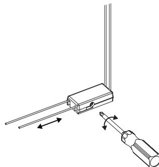
**ВНИМАНИЕ:** Регулировка натяжения шнуров должна производиться равномерно с обеих сторон и только обученным специалистом.
