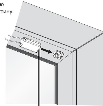
Вытащить нижнее крепление шнура из профиля и зафиксировать на установленной внизу монтажной пластинке.
