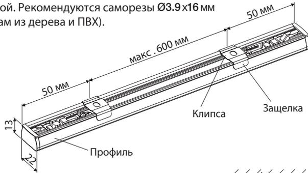
**Внимание:** рекомендуется устанавливать клипсы защелками вперед (внутри комнаты). Клипсы могут быть развернуты защелками назад, к окну или стеклу, при зазоре между ними и профилем минимум 7 мм.
