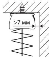
**Монтаж:** вставить край профиля под углом в клипсу (напротив защелки), подтянуть другой край профиля вверх в клипсу: профиль должен защелкнуться.
